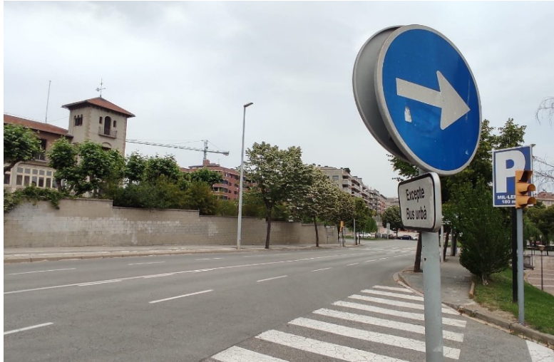
Imatge 9.1 Sortida de l'estació d'autobusos, amb el faldó (descol·locat) que indica excepció per al bus urbà en l'obligatorietat de girar a la dreta. Es poden observar les línies discontinües actuals.
